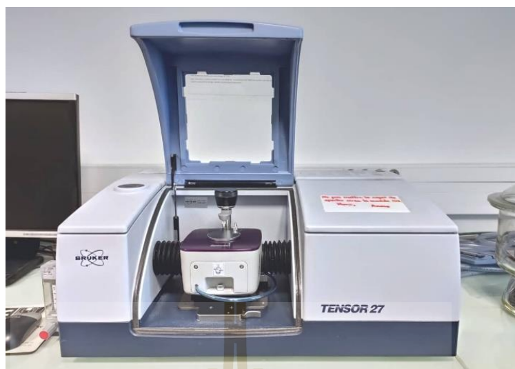
รูปที่ 3.8 เครื่อง Bruker Tensor 27 และอุปกรณ์เสริม Attenuated Total Reflectance (ATR) (ที่มา: https://ceisam.univ-nantes.fr/en/equipment/optical-spectroscopy/ )
