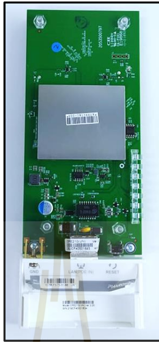
รูปที่ 3.38 แผงวงจรประมวลผลสัญญาณของสายอากาศ
