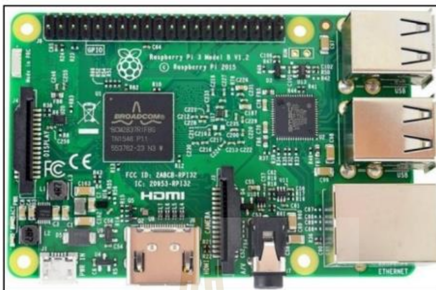
รูปที่ 2.4 บอร์ดระบบสมองกลฝังตัว Raspberry Pi 3 Model B (ที่มา: http://store.dolphinlabs.in/index.php/product/raspberry-pi-3-model/ , 2566)
