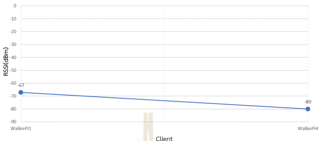
รูปที่ 4.11 กราฟผลการทดสอบประสิทธิภาพระบบการสื่อสารด้วยเสียงด้วยโครงข่ายสื่อสารไร้สาย ด้วยค่าความแรงสัญญาณภาครับสำหรับการสื่อสารแบบหลายจุดภายในโนดหลัก
