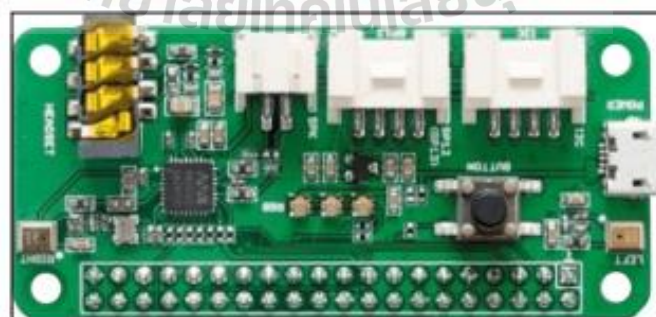
รูปที่ 2.5 โมดูล ReSpeaker 2-Mics Pi HAT (ที่มา: https://www.reichelt.com/de/en/respeaker-2-mic-hat-for-raspberry-pi-rpi-resp-2mic-p248718.html , 2566)
