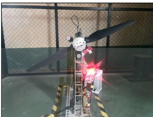
รูปที่ 4.2 RCBenchmark 1780 test stand with BLDC motor, propeller, and battery.
