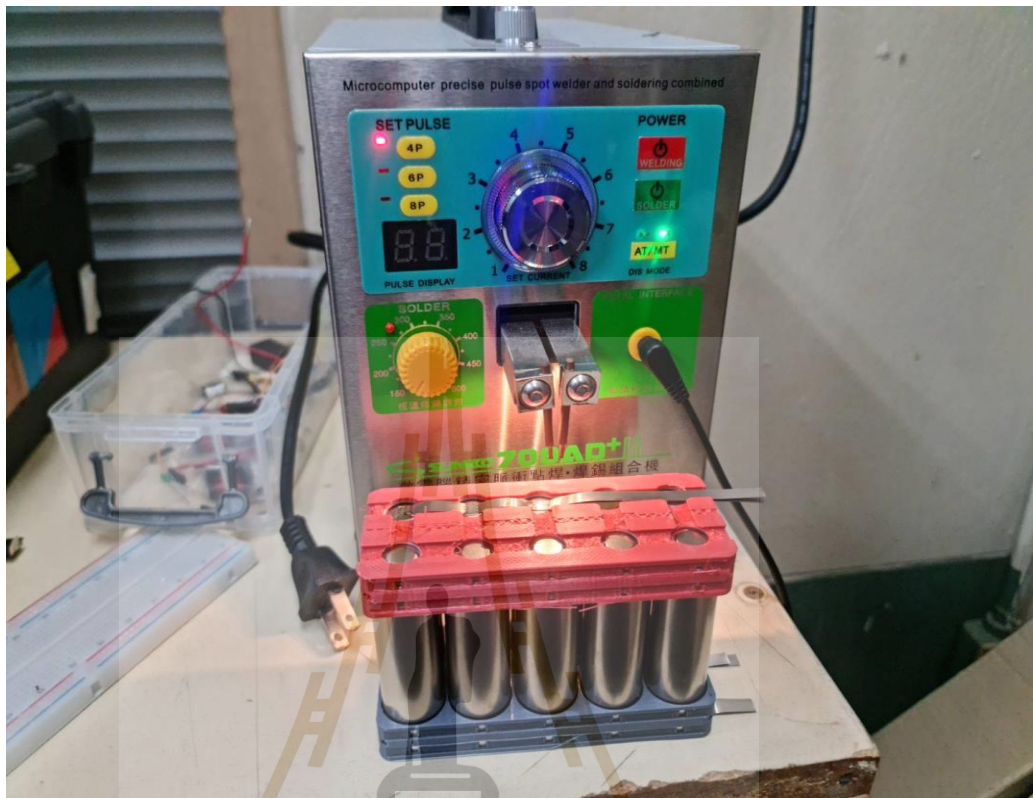
รูปที่ ค.3 Spot welding 1
