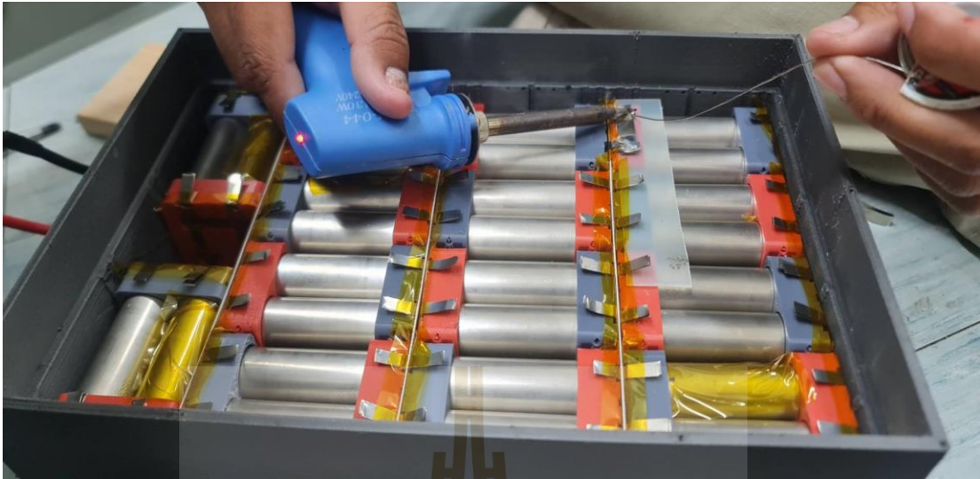
รูปที่ ค.7 Wiring BMS to battery
