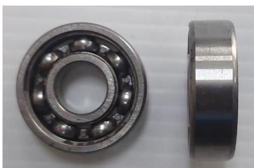
รูปที่ 3.12 ตลับลูกปืนในสถานะขาดสารหล่อลื่น
