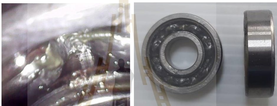
รูปที่ 3.13 ตลับลูกปืนในสถานะเกิดความเสียหายที่รางใน
