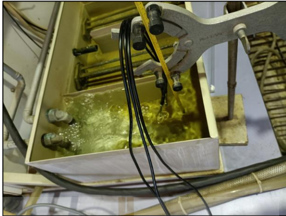
รูปที่ 4.12 เครื่อง Water Bath ชุดทดลองการแลกเปลี่ยนความร้อน
