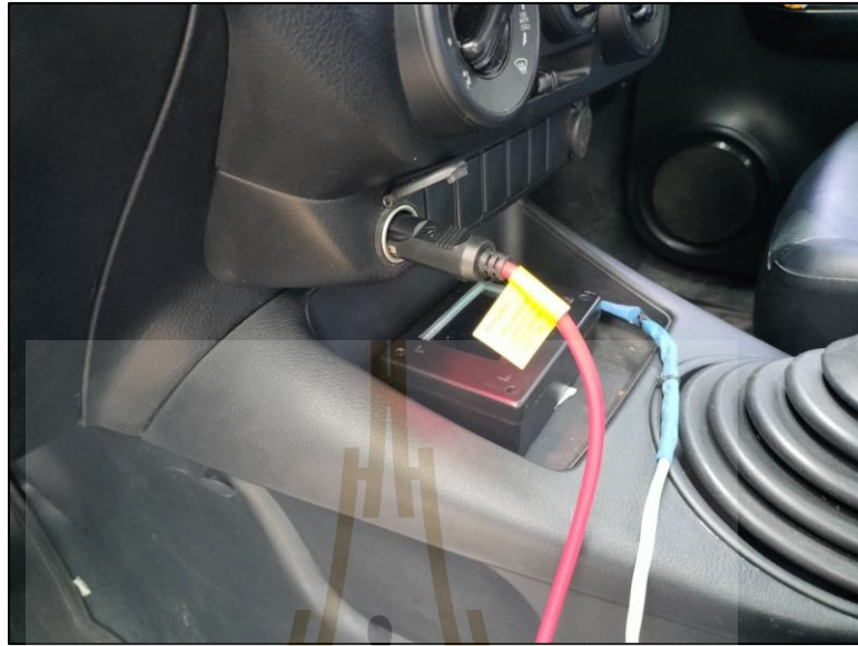
รูปที่ ข.1 แหล่งจ่ายไฟชุดอุปกรณ์ต้นแบบหัวเสียบที่จุดบุหรี่ 12v/24v (10A)
