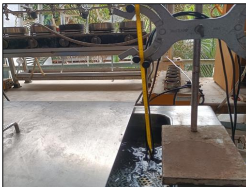
รูปที่ 4.11 เครื่อง Water Bath ชุดทดลองการแลกเปลี่ยนความเย็น
