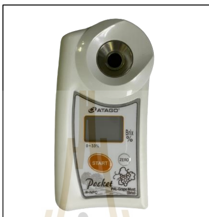
รูปที่ 3.5 เครื่องวัดการหักเหของแสง (Pocket refractometer) ATAGO รุ่น PAL-Grape Must (Brix)
