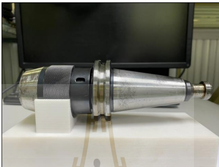
รูปที่ 3.7 ตัวจับดอกสว่าน (Tool holder) รุ่น SK40 DIN69871A
