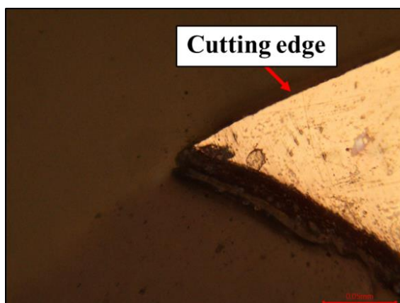
(ก) ดอกสว่านเหล็กกล้าความเร็วสูงเคลือบผิวมัลติโคต
