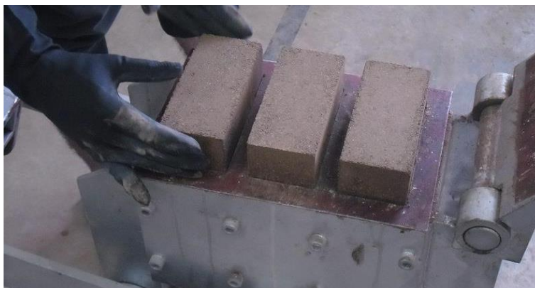
รูปที่ 2.3 การขึ้นรูปอิฐในรูปแบบการอัดแห้ง (สยามรัฐ, 2564)
