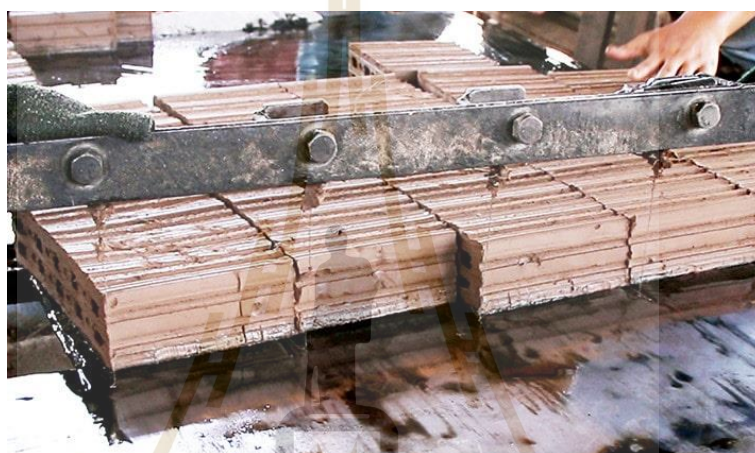
รูปที่ 2.2 การขึ้นรูปอิฐในรูปแบบกระบวนการโคลนแข็ง (อิฐแดง 2009, 2564)
