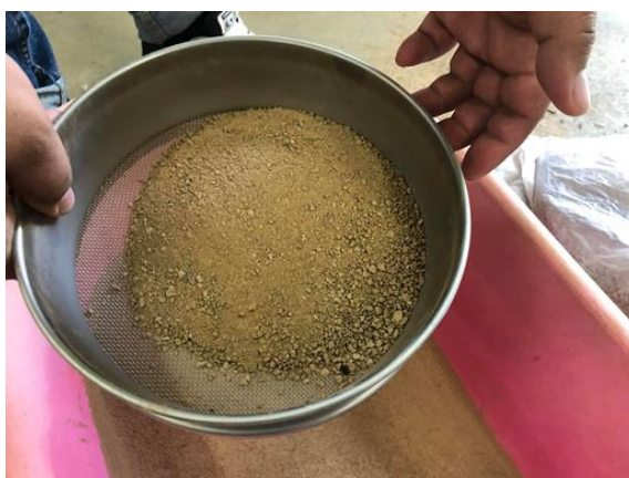
รูปที่ 3.16 ทำการร่อนดินเพื่อคัดกรองสิ่งแปลกปลอม
