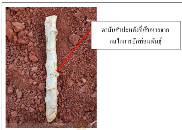
รูปที่ 3.15 ท่อนพันธุ์ที่เสียหายจากกลไกการปักท่อนพันธุ์จะมีรอยที่ตามนท่อนพันธุ์
