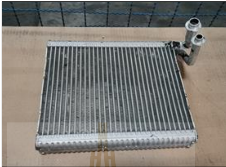
รูปที่ ช.7 คอยล์เย็นทดสอบขนาดความกว้าง 236 มิลลิเมตร และความสูง 205 มิลลิเมตร
