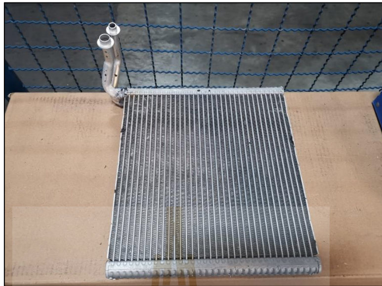
รูปที่ ข.15 คอยล์เย็นทดสอบขนาดความกว้าง 266 มิลลิเมตร และความสูง 295 มิลลิเมตร
