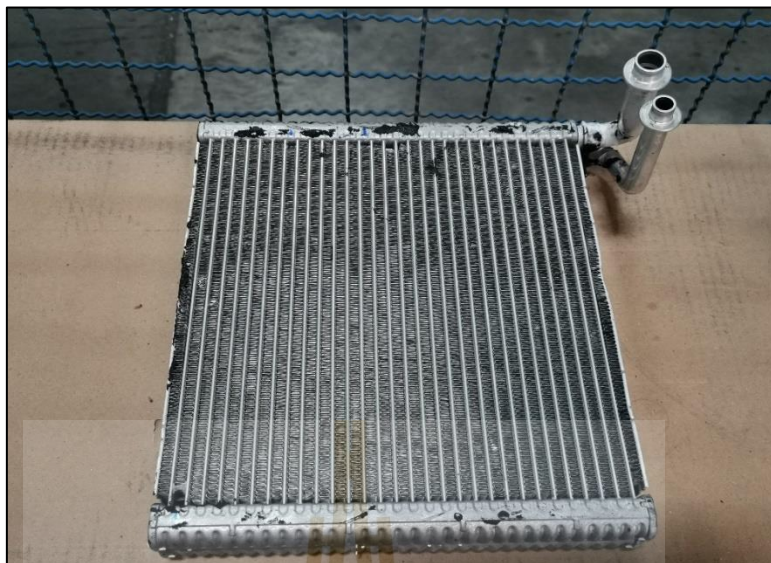
รูปที่ ช.9 คอยล์เย็นทดสอบขนาดความกว้าง 236 มิลลิเมตร และความสูง 265 มิลลิเมตร
