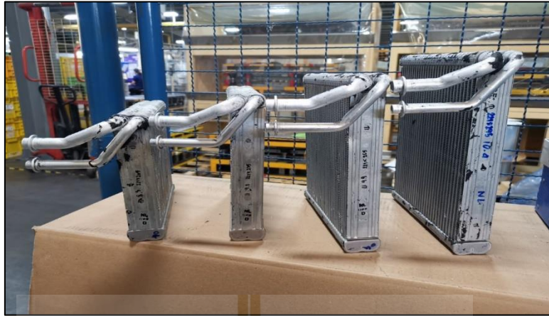
รูปที่ ช.1 คอยล์เย็นทดสอบขนาดความกว้าง 221 มิลลิเมตร
