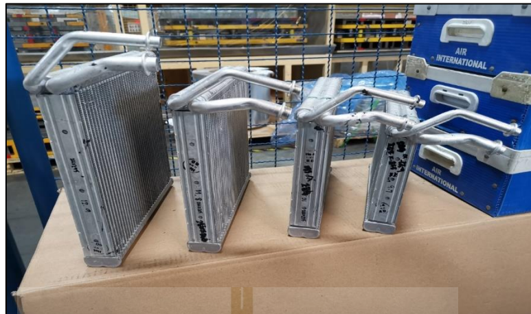
รูปที่ ช.11 คอยล์เย็นทดสอบขนาดความกว้าง 266 มิลลิเมตร
