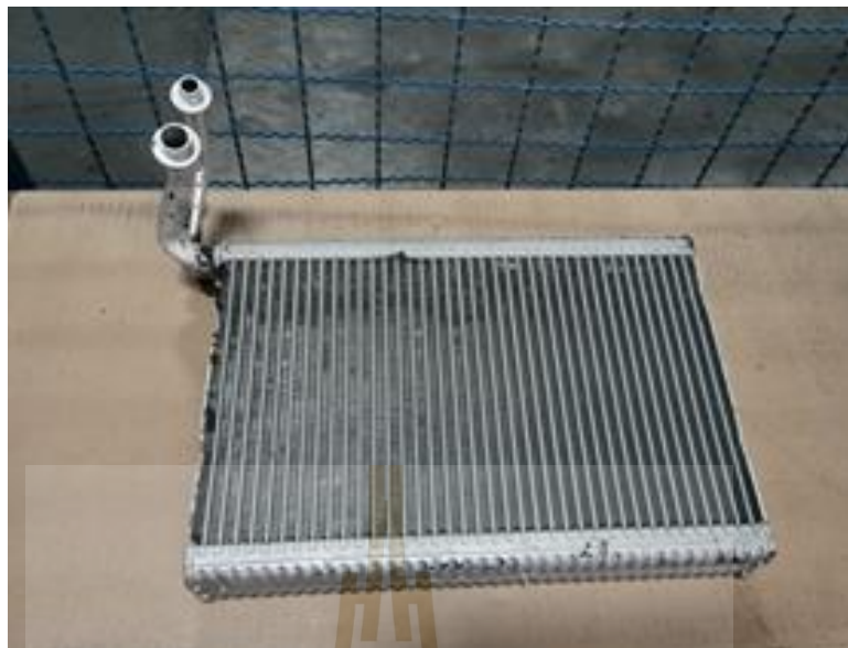
รูปที่ ช.17 คอยล์เย็นทดสอบขนาดความกว้าง 297 มิลลิเมตร และความสูง 205 มิลลิเมตร
