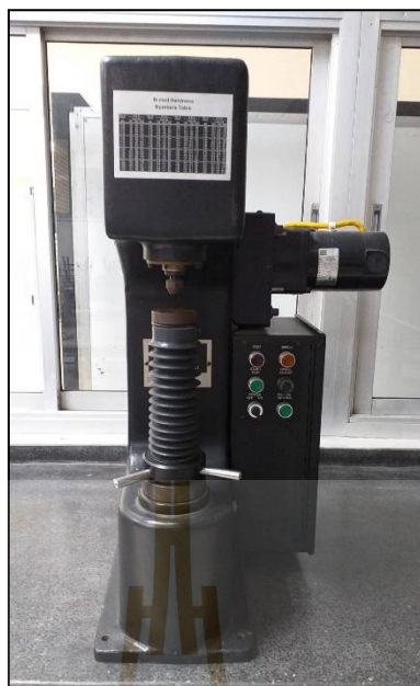
รูปที่ 3.9 เครื่องทดสอบความแข็งแบบบริเนล Wilson รุ่น MJ
