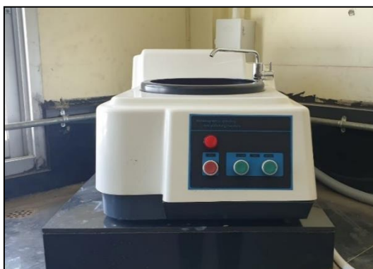
รูปที่ 3.13 เครื่องวัดกระดาศทราขแบบละเอียดและเครื่องวัดฟ้าสักหลาด
