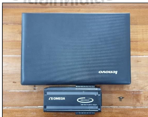
รูปที่ 3.4 เครื่องบันทึกอุณหภูมิ หรือ Data Logger
