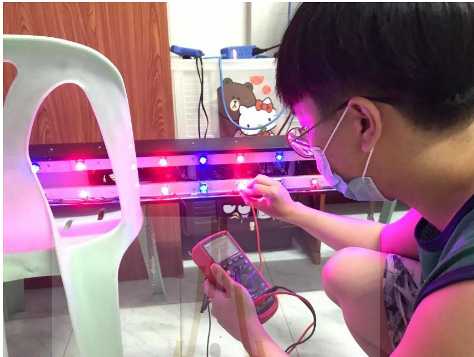
รูปที่ 4.32 แสดงการเชื่อมต่อ Digital Multimeter เพื่อการทดลอง
