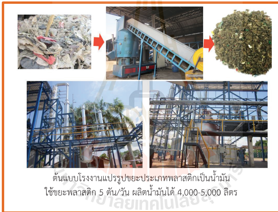
ภาพที่ 3.7 การแปรรูปขยะประเภทพลาสติกเป็นน้ำมัน ศูนย์ความเป็นเลิศทางด้านชีว มวล มหาวิทยาลัยเทคโนโลยีสุรนารี (ที่มา : ศูนย์ความเป็นเลิศทางด้านชีวมวล มหาวิทยาลัยเทคโนโลยีสุรนารี)
