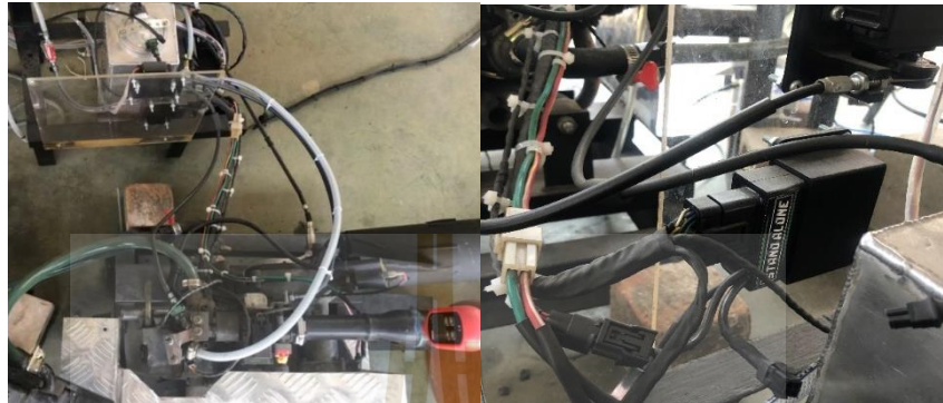
รูปที่ 3.18 ชุดติดตั้งสายไฟเข้ากล่อง ECU
