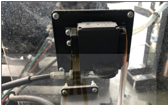
รูปที่ 3.16 เซอร์โวมอเตอร์ควบคุมการเปิด-ปิดของลิ้นผีเสื้อ
