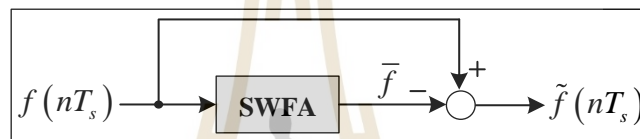
รูปที่ 4.8 การแยกปริมาณทางไฟฟ้าด้วยการวิเคราะห์แบบฟูรีเยร์วินโดว์เลื่อน
