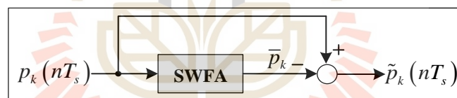
รูปที่ 4.9 การแยกปริมาณกำลังไฟฟ้าขณะหนึ่งสัญญาณตรงและสัญญาณสลับ
