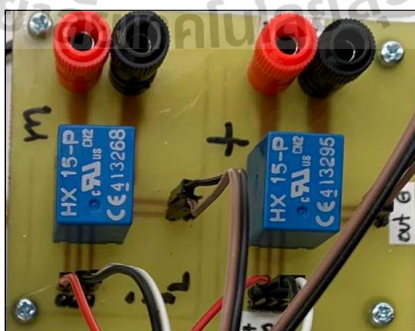
รูปที่ 9.16 ตัวตรวจวัดกระแสไฟฟ้าวรุ่น LEM HX15-P
