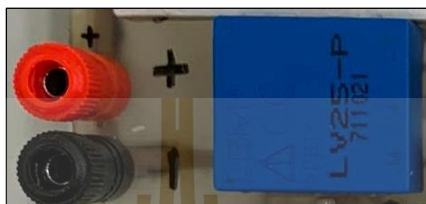
รูปที่ 9.17 ตัวตรวจวัดแรงดันไฟฟ้ากระแสตรงรุ่น LEM LV-25P
