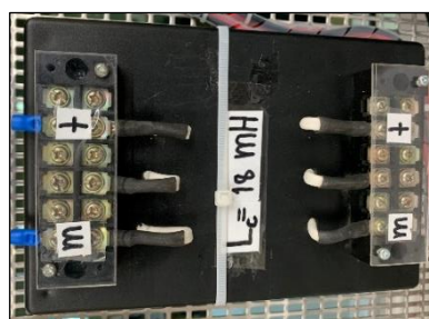
รูปที่ 9.11 ตัวเหนี่ยวนำของวงจรกรองกำลังแอกทีฟ
