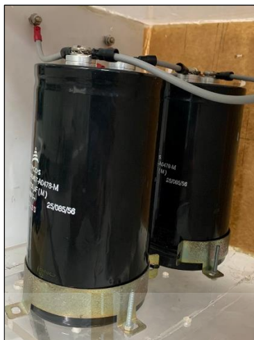
รูปที่ 9.14 ตัวเก็บประจุของวงจรกรองกำลังแอกทีฟ
