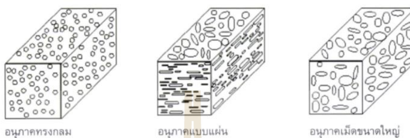
รูปที่ 2.2 วัสดุคอมพอสิตเสริมแรงด้วยอนุภาค (Particle -Reinforced Composites) (German, R. M. ,2016)
