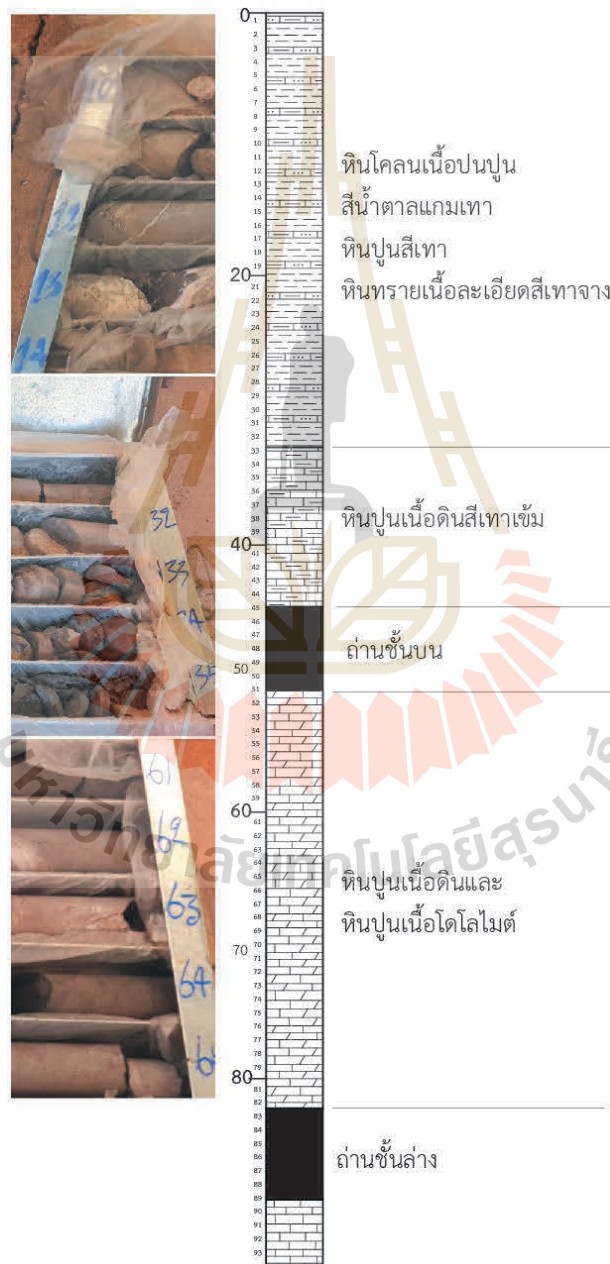
รูปที่ 3.10 แท่งลำดับชั้นหินของหลุมเจาะที่ศึกษา
