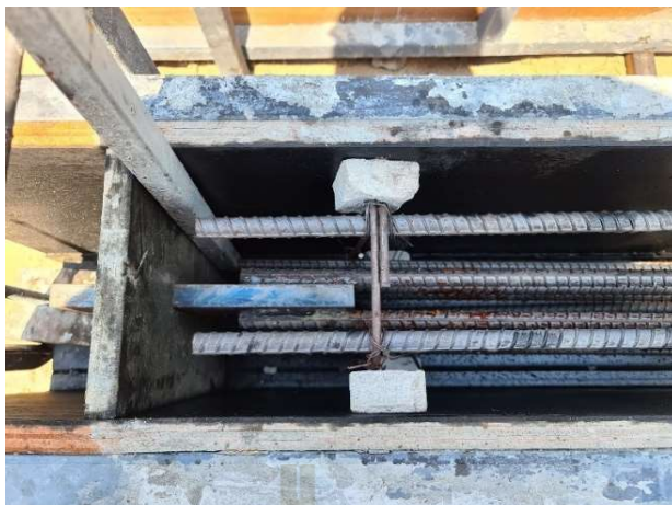
รูปที่ 3.12 เหล็กข้ออ้อยที่เชื่อมกับแผ่นเหล็กที่ฝังที่ส่วนรองรับของคานตัวอย่างทดสอบ
