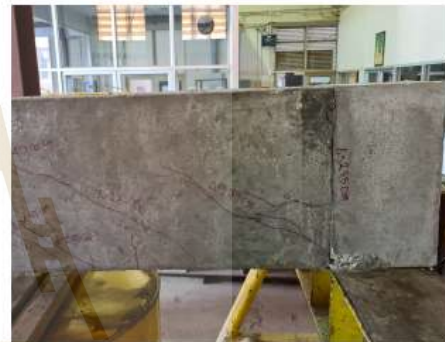
(b) ลักษณะการวิบัติของคานตัวอย่างทดสอบที่มีเหล็กข้ออ้อยระยะฝึงเท่ากับ 1.0 และ 1.5 ม.
