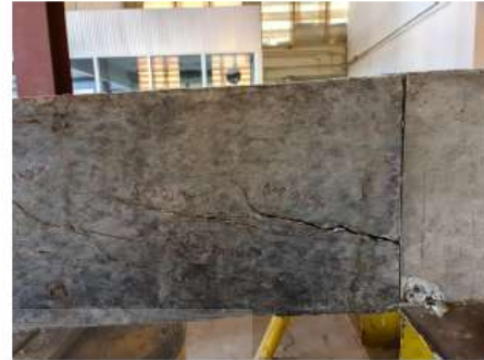
(a) ลักษณะการวิบัติของคานตัวอย่างทดสอบที่มีเหล็กข้ออ้อยระยะฝึงเท่ากับ 0.5 ม.
