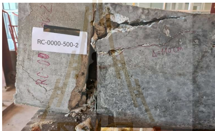
รูปที่ 4.17 ลักษณะการวิบัติของคานตัวอย่างทดสอบที่ไม่มีเหล็กข้ออ้อยเชื่อมกับแผ่นเหล็กกลุ่มที่ 3
