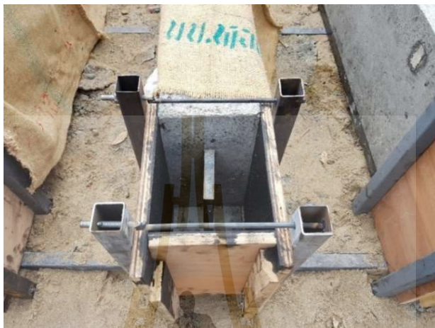
รูปที่ 3.14 แบบหล่อที่ปิดส่วนแผ่นเหล็กที่ยื่นออกมาจากคานตัวอย่างทดสอบ
