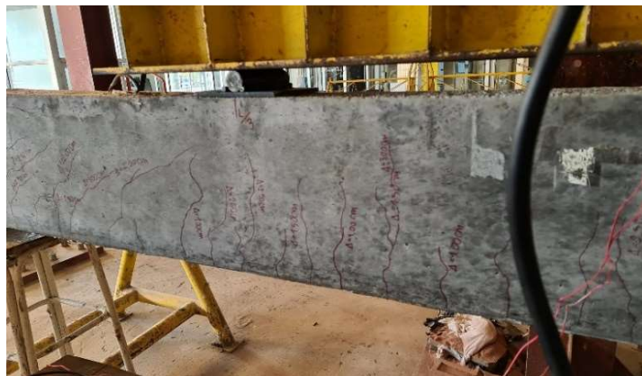
รูปที่ 4.14 ลักษณะการวิบัติของคานตัวอย่างทดสอบที่มีเหล็กข้ออ้อยเชื่อมกับแผ่นเหล็กกลุ่มที่ 1
