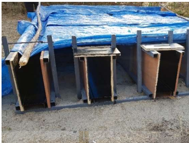
รูปที่ 3.10 แบบหล่อคานตัวอย่างทดสอบที่ใช้ในงานวิจัย
