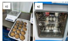
รูปที่ 1 ก) ข้าวเปลือกตัวอย่างที่บรรจุในถ้วยชั่งน้ำหนัก ข) เครื่องอบความชื้นแบบ Hot air oven
