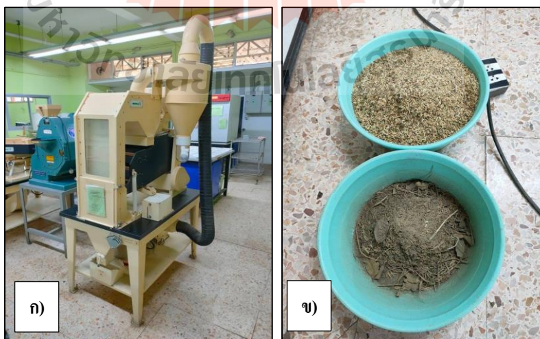
รูปที่ 3.3 การคัดแยกข้าวเมล็ดลีบและสิ่งเจือปนออกจากตัวอย่าง ก) เครื่องทำความสะอาดเมล็ดพันธุ์โดยตะแกรงและแรงลม ข) สิ่งเจือปนที่ถูกแยกออกจากตัวอย่าง
