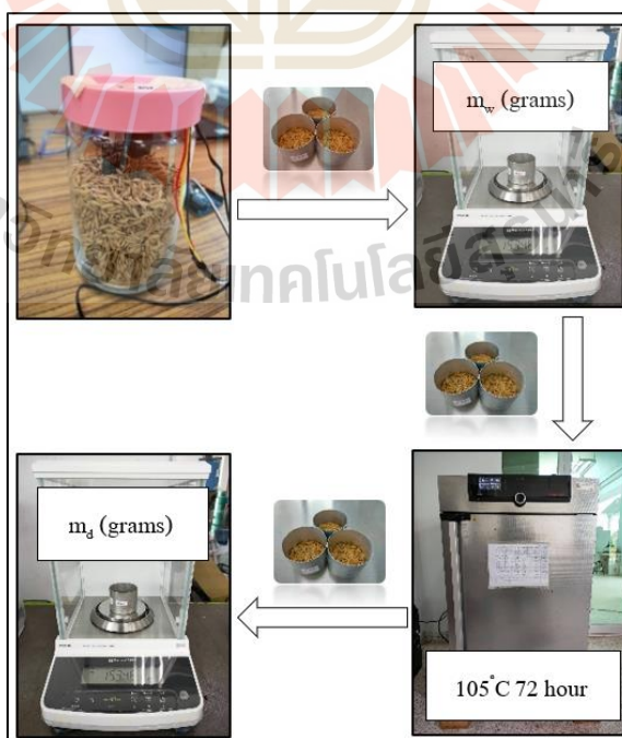
รูปที่ 3.20 การตรวจสอบความชื้นข้าวเปลือก
