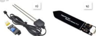
รูปที่ 3 ก) เซนเซอร์วัดความชื้นในดินชนิดต้านทาน ข) เซนเซอร์วัดความชื้นในดินชนิดเก็บประจุ
