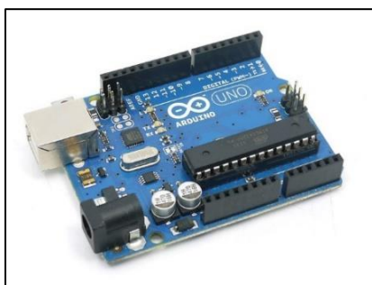
รูปที่ 3.10 บอร์ด Arduino Uno R3
