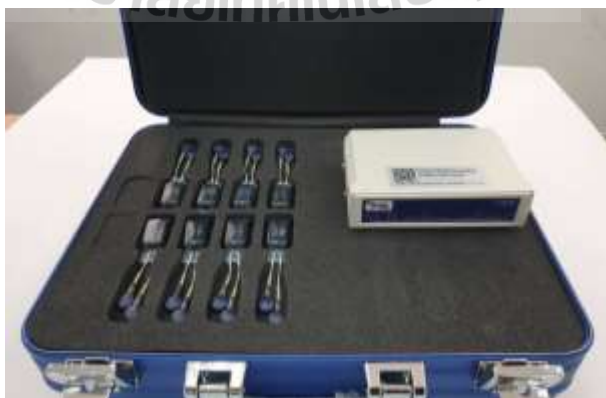
รูปที่ 3.7 ชุดวัดสัญญาณศักย์ไฟฟ้าของกล้ามเนื้อ
