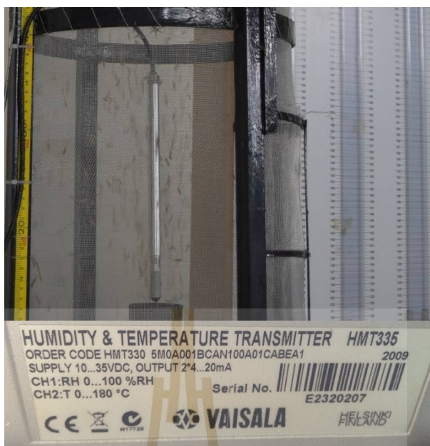
รูปที่ ข.6 เครื่องวัดอุณหภูมิและความชื้นที่ใช้ในการทดลอง
