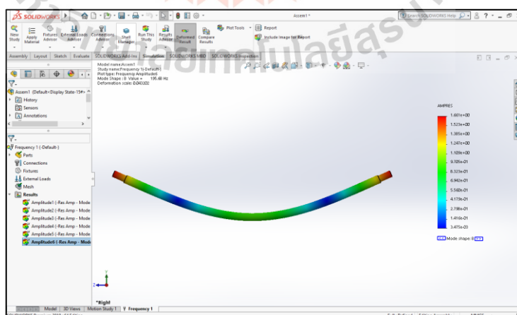
รูปที่ ก.6 ผลลัพธ์จากการประมาณค่าความถี่ธรรมชาติด้วยโปรแกรม SolidW
