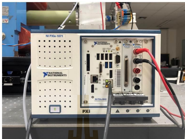
รูปที่ 4.14 อุปกรณ์ NI-PXIe-8840 Embedded Controller พร้อมกับ NI PXIe-1071 Power supply with 4 chassis ของ National Instruments
