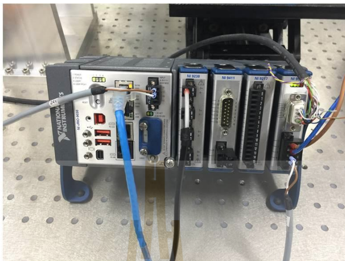
รูปที่ 4.5 อุปกรณ์ควบคุมแบบ NI-CompactRIO รุ่น NI cRIO-9030
