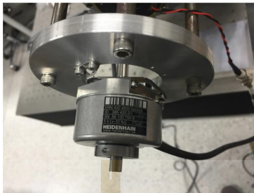
รูปที่ 4.8 อุปกรณ์อ่านค่าตำแหน่งเชิงมุม (Rotating Encoder) รุ่น ERN-420 ของ Heidenhain
