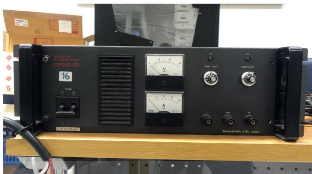
รูปที่ 4.13 แหล่งจ่ายกระแสไฟฟ้ากระแสตรง (Regulated DC Power supply) รุ่น GP060-60 ของ Tagasago
