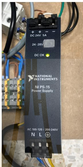
รูปที่ 4.18 แหล่งจ่ายกำลังไฟฟ้ากระแสตรงแบบสวิทชิง ( Switching DC power supply) รุ่น NI PS-15 ของ National Instruments
