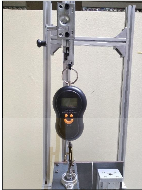
รูปที่ 3.5 จุดที่ติดตั้งเครื่องชั่งดิจิตอลชนิดแขวน
