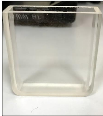
รูปที่ 3.17 อุปกรณ์บรรจุตัวอย่างทดสอบการวัดสี
