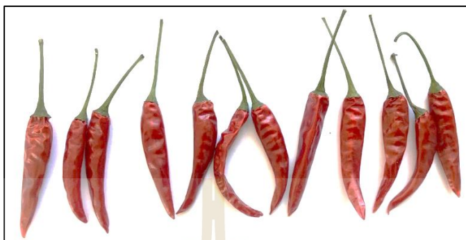
รูปที่ 4.12 ตัวอย่างการนำพริกชี้หนูแดงอบแห้งด้วยเครื่องอบแห้งต้นแบบที่เปิดการทำงานของฮีตเตอร์ไฟฟ้าเพียงอย่างเดียวในการผลิตอากาศอบแห้ง
