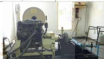
รูปที่ 4.1 เครื่องยนต์ดีเซลหมุนเร็วและอุปกรณ์ที่ใช้ในงานวิจัย
