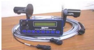
รูปที่ 5 เครื่องมือวิเคราะห์ควันท้า WAGER รุ่น 6500
