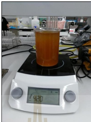
รูปที่ 3.4 การทำปฏิกิริยาทรานส์เอสเทอร์ฟิเคชัน
