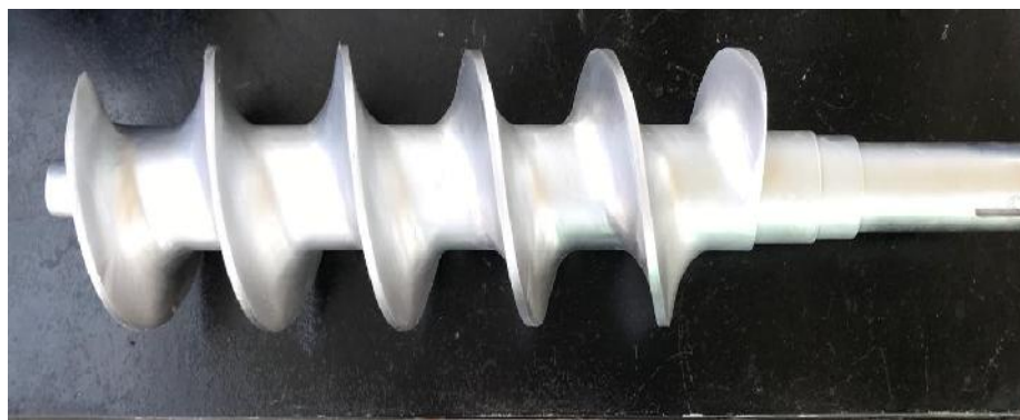
รูปที่ 4.7 สกรุดันแบบที่ได้จากการคำนวณขนาดความลึกของช่องสกรู
