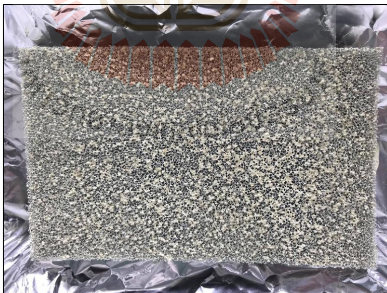
รูปที่ ง.4 ชิ้นงานฟองน้ำตัวเร่งปฏิกิริยากราฟิติการ์บอนไนโตรดัดหลังการอบ
