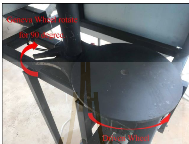
รูปที่ 3.15 การเคลื่อนที่ของเฟืองขับและเฟืองเจนีวา
