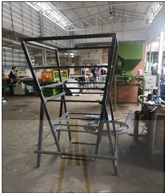
รูปที่ 3.13 โครงสร้างของเครื่องอบแห้งปล่องลมแดด
