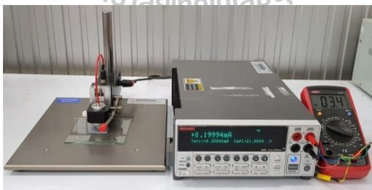
รูปที่ 3.7 เครื่องมือวัดความต้านทานแบบสี่หัวเข็ม (4-point probes)
