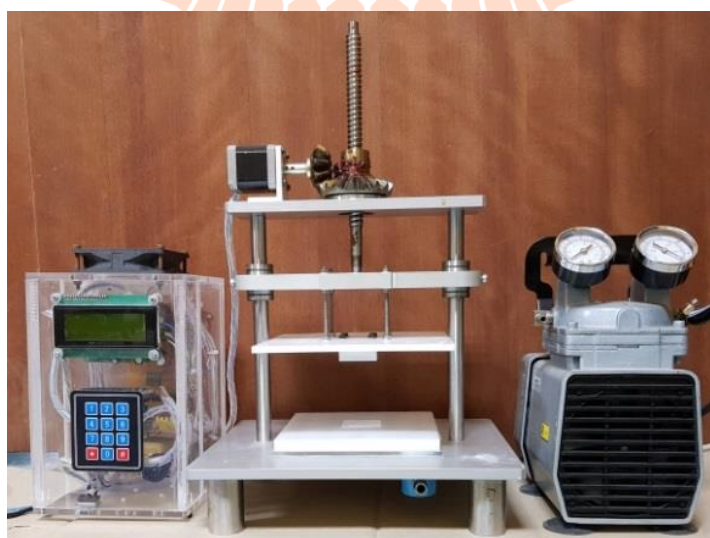
รูปที่ 3.4 เครื่องประทับลายกึ่งอัตโนมัติ
