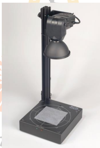
รูปที่ 4.16 เครื่อง Photoconductance lifetime tester รุ่น WCT-120
