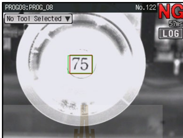
รูปที่ 4.17 ตัวอย่างงานเสียที่พบในเวลากลางคืนเค้าโครงและพื้นที่หมึกมีไม่สมบูรณ์ตัดสินไม่ผ่าน
