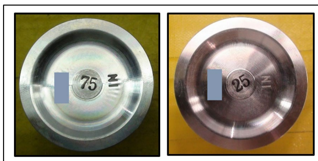
รูปที่ 1.2 ตัวอย่างชิ้นงานประตัทบตราไม่ตรงตำแหน่ง หรือเอียง
