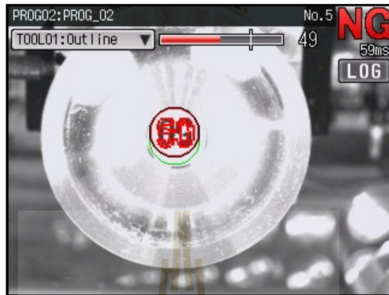
รูปที่ 4.2 ตัวอย่างผลการตรวจสอบประทับตราชิ้นงานกลับด้านตรวจสอบ จากเค้าโครง 49% ตัดสินเป็นงานเสีย
