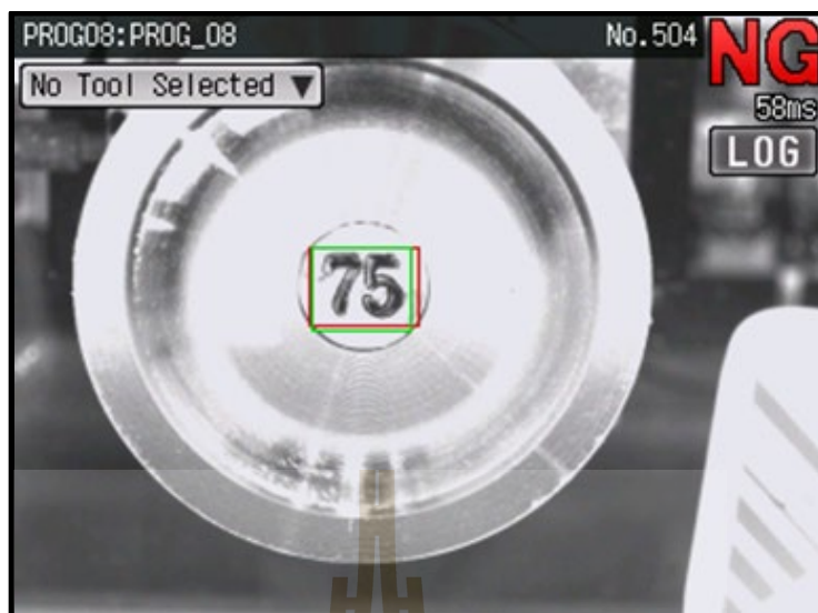
รูปที่ 4.21 ตัวอย่างงานเสียที่พบในเวลากลางคืนเมื่อนำการประเมินทั้งค่าโครงและพื้นที่หมึกมารวมกันภาพจึงเกิดความไม่สมบูรณ์ไม่สมบูรณ์ตัดสินไม่ผ่าน
