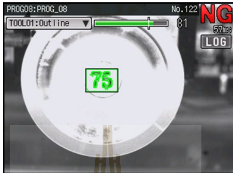
รูปที่ 4.15 ตัวอย่างงานเสียที่พบในเวลากลางคืนเค้าโครงชิ้นงานมีความเหมือน 81% ตัดสินผ่าน
