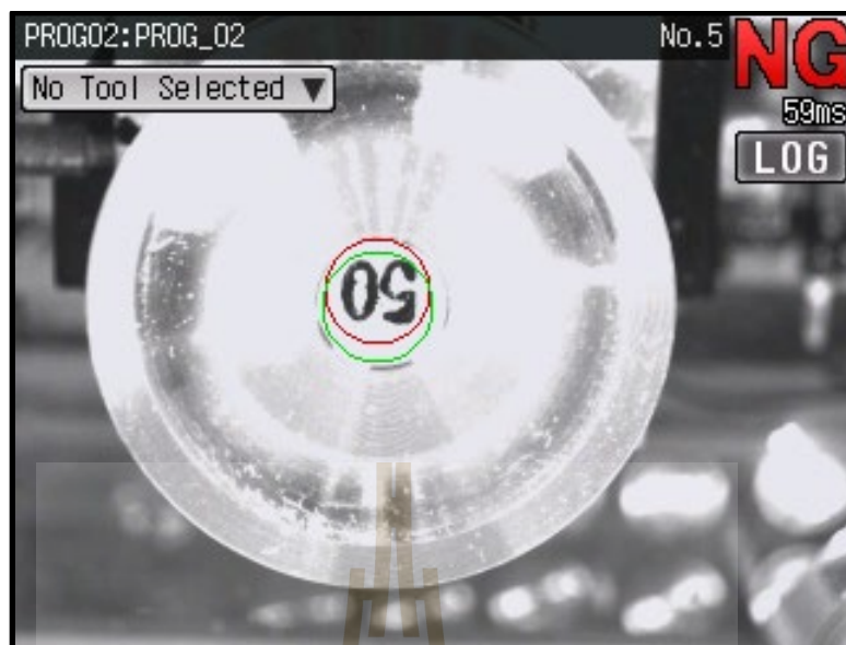
รูปที่ 4.4 ตัวอย่างผลการตรวจสอบประสิทธิภาพชิ้นงานกลับด้านตรวจสอบเก้าโครง และพื้นที่หมึกตัดสินเป็นงานเสียไม่ได้มาตรฐาน
