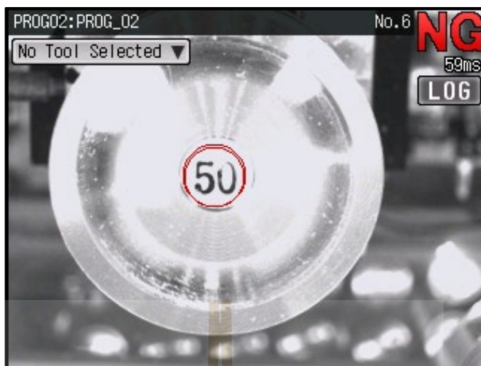
รูปที่ 4.10 ตัวอย่างผลการตรวจสอบประทับตราชิ้นงานไม่ชัดเจนตรวจสอบเค้าโครง และพื้นที่หมึกคัดลिनเป็นงานเสียไม่ได้มาตรฐาน
