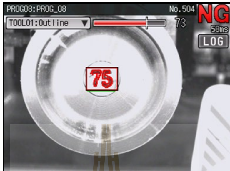
รูปที่ 4.19 ตัวอย่างงานเสียที่พบในเวลากลางคืนเค้าโครงชิ้นงานมีความเหมือน 73% ตัดสินไม่ผ่าน
