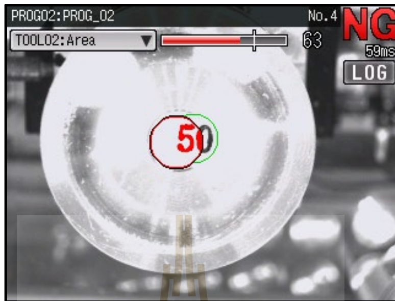
รูปที่ 4.6 ตัวอย่างผลการตรวจสอบประสิทธิภาพชิ้นงานไม่ตรงตำแหน่ง ตรวจสอบจากพื้นที่ 63% ตัดสินเป็นงานเสีย
