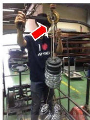
รูปที่ 10 ทดสอบระยะยุบตัวโครงหลังคา
