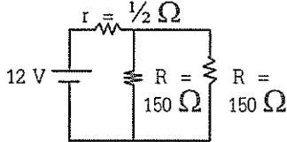
เมื่อ  $r$  คือ ความต้านทานภายในของแบตเตอรี่ และ  $R$  คือ ความต้านทานหลอดไฟแต่ละดวงที่ต่อขนานกัน
