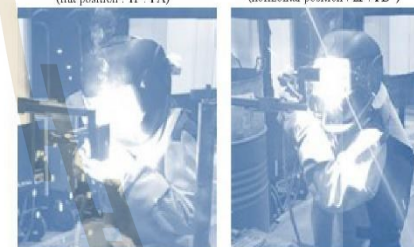
รูปที่ 2 ลักษณะการเชื่อมตัวอย่างเลข ตาม 4 ท่าเชื่อมมาตรฐาน
