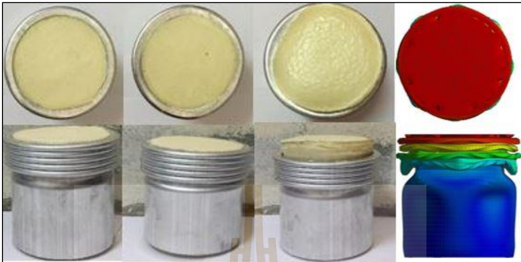
รูปที่ 4.6 การเสียรูปของการทดสอบและการวิเคราะห์ด้วยโปรแกรม
