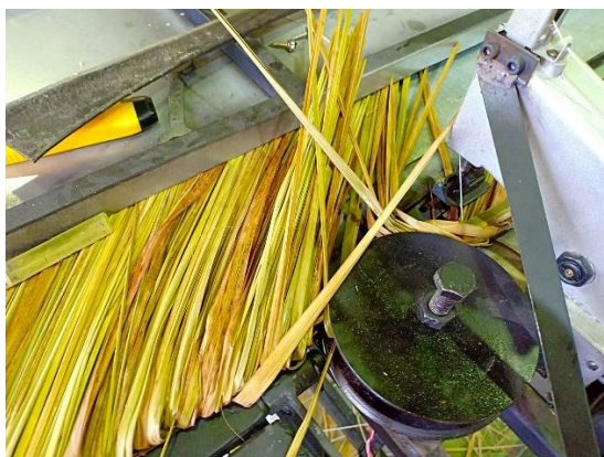
รูปที่ 4.2 การติดตั้งของดัดหน้าที่ยบริเวณกลไกป้อนหน้า
