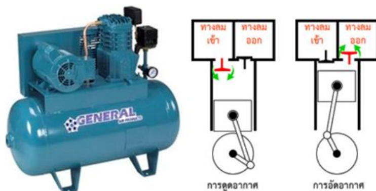
รูปที่ 2.7 เครื่องอัดอากาศแบบลูกสูบและการทำงาน (ณัฐพงษ์ จริตงาม และณิชา ลิ้มเจริญ, ม.ป.ป.)
