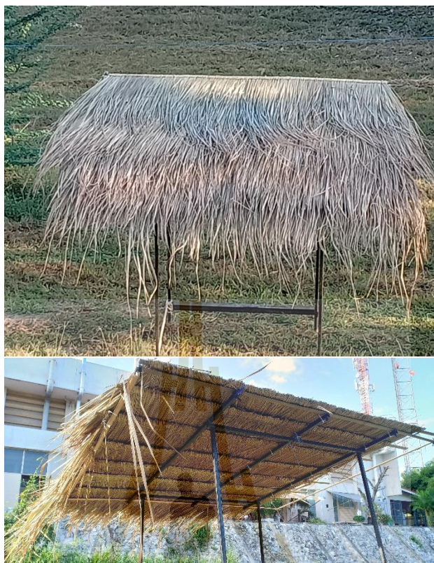
รูปที่ 3.26 การทดสอบการป้องกันความร้อนจากแสงอาทิตย์
