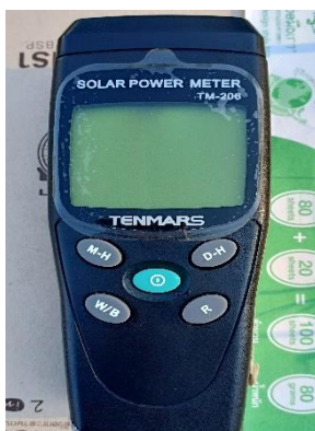
รูปที่ 3.28 เครื่องวัดความเข้มแสงอาทิตย์
