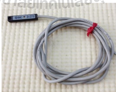
รูปที่ 2.21 Reed Switch (สยามออโตเมชัน, 2561)
