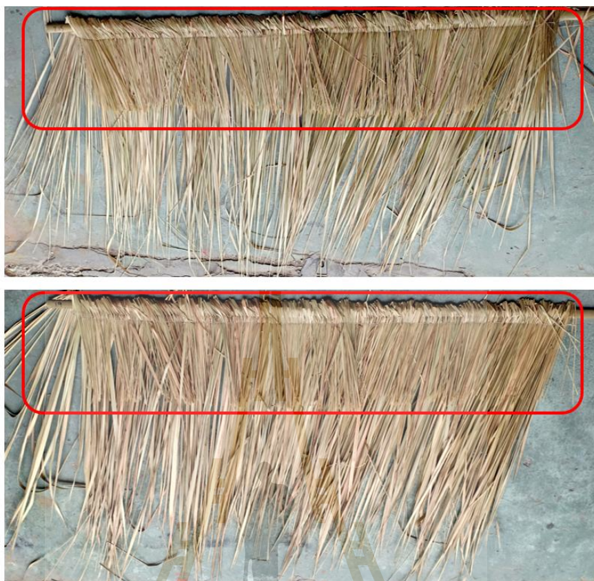
รูปที่ 4.9 ตัวอย่างของต๋ับหญ้ำที่เกดปัญหำแนวพ้บของต๋ับหญ้ำเอียง
