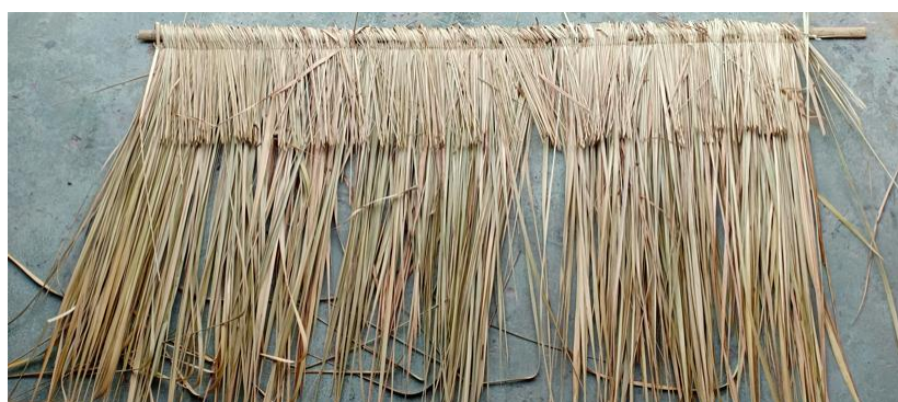
รูปที่ 4.11 ตัวอย่างของดักหญ้าที่เกิดปัญหาการกระจายตัวไม่สม่ำเสมอ
