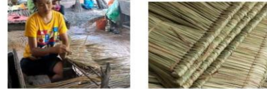
(c) bunches tied on wood rod (d) vetiver grass panel
