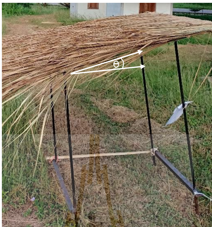
รูปที่ 3.25 มุมเอียงของหลังคาที่ใช้ในการทดสอบ
