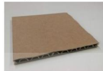
รูปที่ 1 กล่องลูกฟูก 3 ชั้น (Single wall corrugated)
