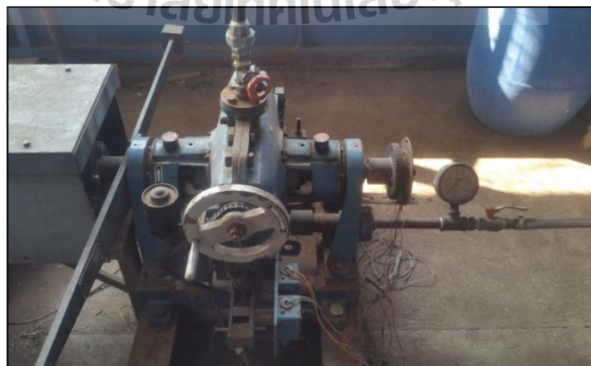
รูปที่ 3.5 ไดนาโมมิเตอร์ ยี่ห้อ SAJ รุ่น AWM-50MLC
