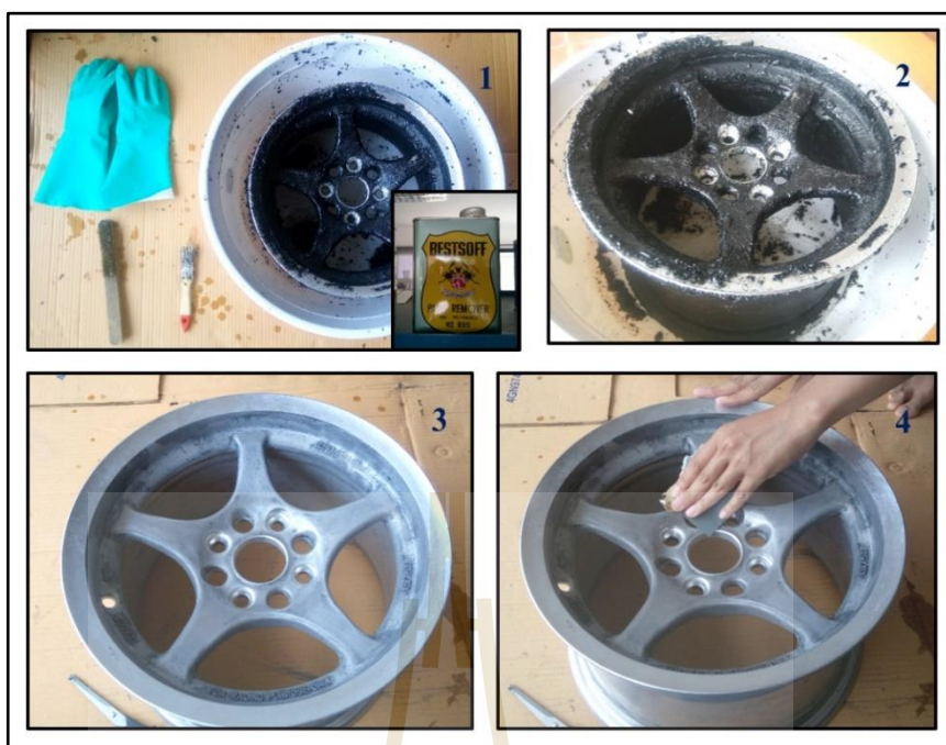
รูปที่ ข.1 การลอกสี้อัลลอยสำหรับการทดสอบการล้าตามุมในเชิงพลวัต
