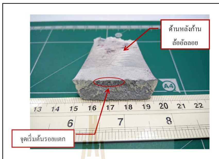
รูปที่ 4.6 ชั้นส่วนแกนล้ออัลลอยที่เสียหายจากการล้า
