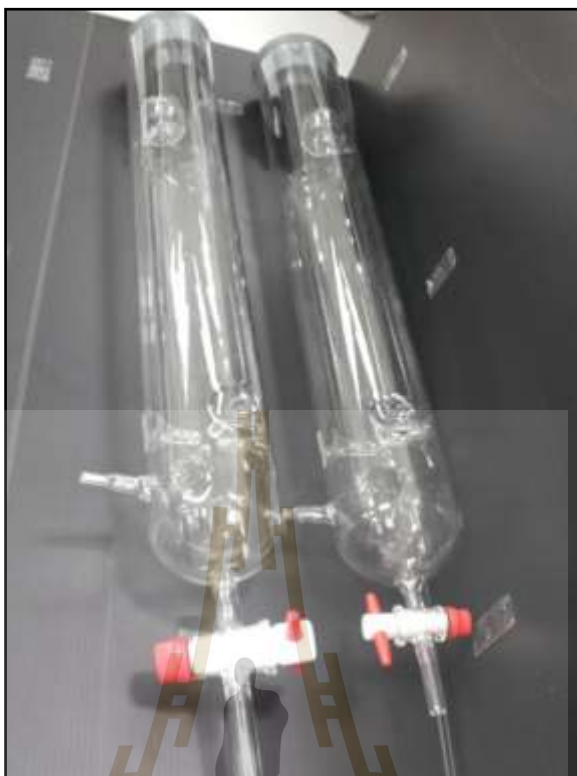
รูปที่ 3.12 คอลัมน์ระบบไบโอสกริบเบอร์ที่ใช้ในการศึกษา
