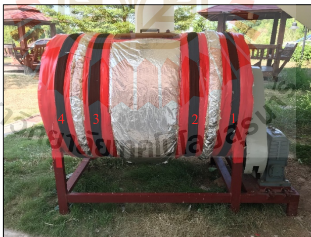
รูปที่ 4.20 ถังอบที่พันลวดครบ 4 ชุดพร้อมนำไปใช้งานอบย่อยสลายขยะอินทรีย์
