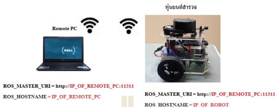
รูปที่ 3.6 การตั้งค่า Network ของหุ่นยนต์สำรวจกับคอมพิวเตอร์
