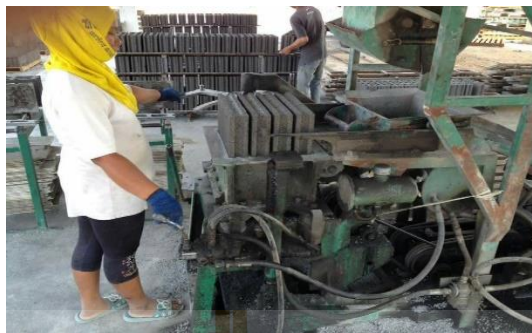
รูปที่ 3.4 การอัดขึ้นรูปจากเครื่องอัดไฮดรอลิก
