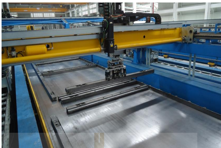
รูปที่ 2.10 การวางเหล็กขึ้นแบบ (Pruksa Real Estate, 2015)
