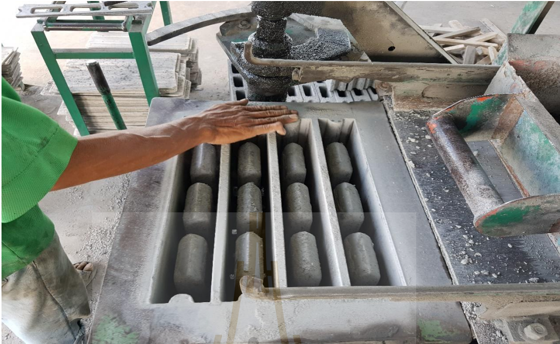
รูปที่ ค.5 การเตรียมแบบอัดคอนกรีตบล็อก
