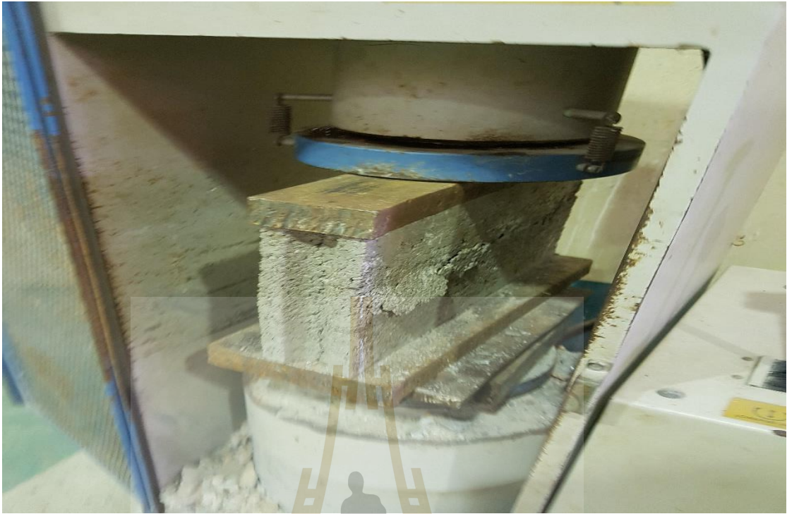
รูปที่ ค.11 การทดสอบกำลังรับแรงอัด และลักษณะการแตกของเต้าลอยจีโอโพลี เมอร์บล็อกผสมกากขานอ้อย
