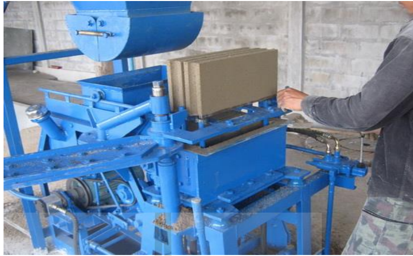
รูปที่ 3.10 เครื่องอัดบล็อกคอนกรีต ด้วยแรงดันไฮดรอลิก
