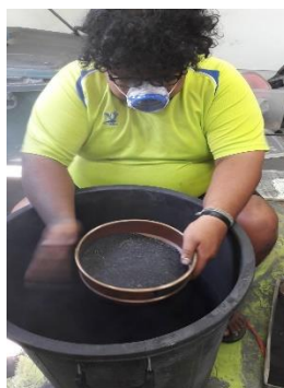
รูปที่ 3.3 เถ้าแกลบที่ร่อนผ่านตะแกรงเบอร์ 10
