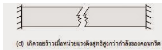
รูปที่ 2.12 แท่งคอนกรีตเกิดรอยร้าว (d)
