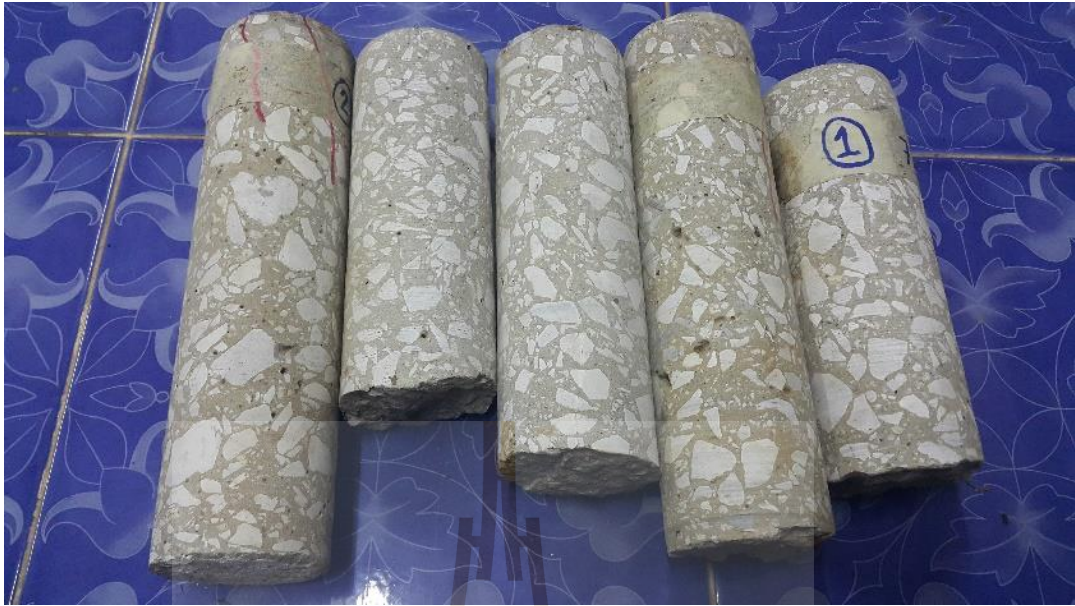
รูปที่ ก.6 แท่งคอนกรีตที่เจาะสำรวจ
