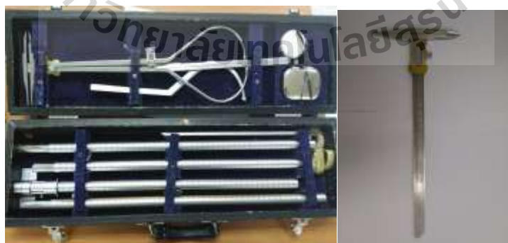
รูปที่ 3.1 เครื่องมือวัดสัดส่วนร่างกายแบบมาร์ติน Anthropometer และ Caliper
