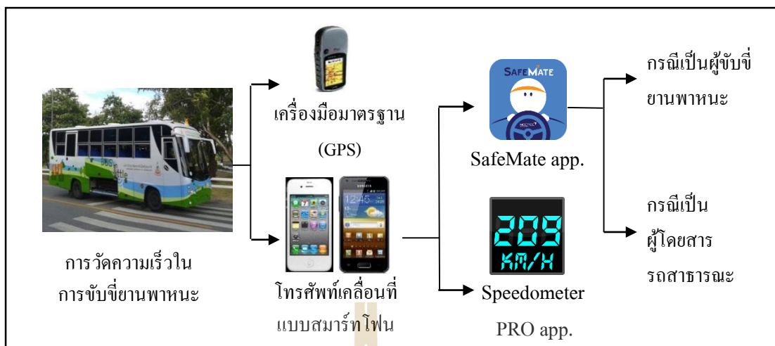
รูปที่ 3.5 เครื่องมือที่ใช้ในการตรวจวัดค่าการเปลี่ยนแปลงความเร็วของยานพาหนะ
