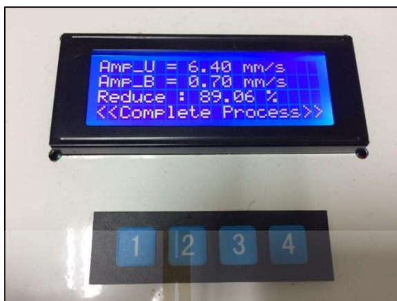
รูปที่ 4.27 ค่าการสั่นสะเทือนที่ลดลงหลังจากการแก้ไขความไม่สมดุลของจานเลือด
