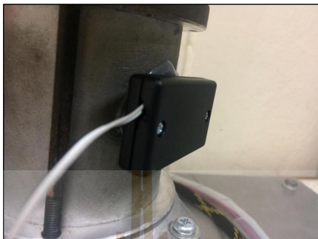
รูปที่ 4.13 ติดตั้ง Accelerometer ที่มอเตอร์ BLDC
